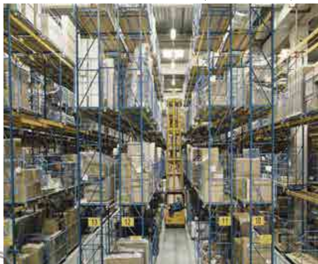
Rack de stockage à palettes (largeur 2700 mm, profondeur 1100 mm)
